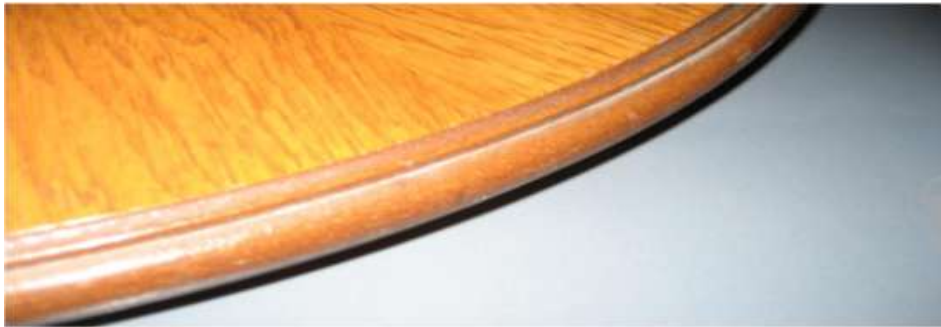
Resim 1.32: Dairesel iş parçasına rulmanlı bıçakla profil açma
