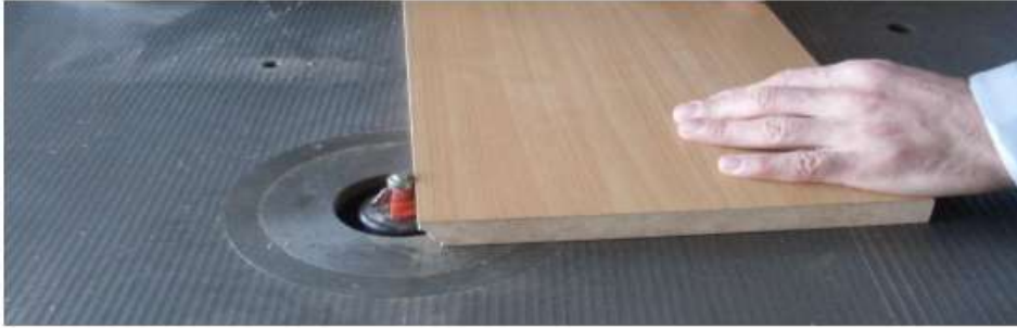
Resim 1.30: Kısa milde rulmanlı bıçakla profil açma
