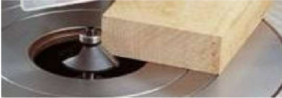
Resim 1.31: Kısa milde rulmanlı bıçakla profil açma
