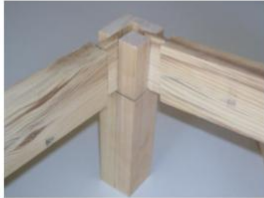
Őekil 2.8: Aık zıvanalı ayak kayıt birleřtirme Resim 2.10: Aık zıvanalı ayak kayıt birleřtirme
